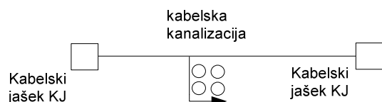
Slika 18: Kabelska kanalizacija s prazno cevjo
