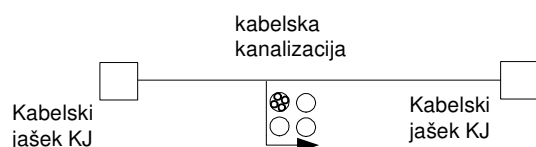
Slika 19: Kabelska kanalizacija s prazno cevjo malega premera
