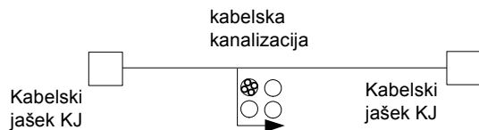
Slika 19: Kabelska kanalizacija s prazno cevjo malega premera
