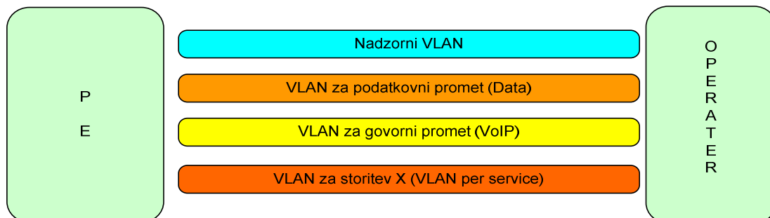
Slika 2: Logična konfiguracija povezave Telekom Slovenije – operater
