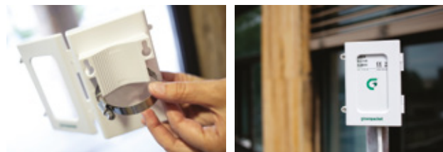
Slika 9: Namestitev cevne objemke na zunanje ohišje
