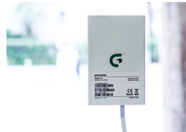
Slika 6: Prikaz namestitve sprejemnika H5 na okensko steklo
